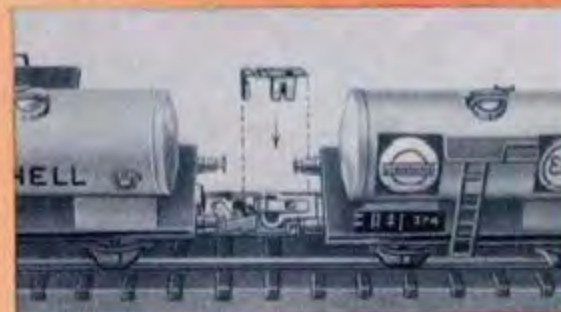
Wagen 374 S mit normaler Kupplung und Wagen 374 StK mit neuer automatischer Kupplung durch Zusatzkupplung 360 ZK miteinander verbunden
