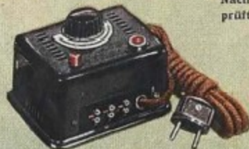
270 A/...Volt 17.50 Transformator für Perfekt-Schaltung Stufenlose Regelung (2 Nullstellungen), Kurz- schluß-Automat, rotes Kontroll-Licht, Druck- knopf für Umschaltung, Anschlüsse für Bahn, Licht und elektromagnetische Artikel. Leistung 25 VA
