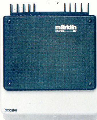
6015 · Booster · Amplificateur de puissance pour l'alimentation de parties de réseaux importants · Courant de sortie max. 2,5 A · Etat de fonctionnement signalé par LED · 2 jacks, un pour branchement à la Central Unit, l'autre pour le branchement d'un Booster supplémentaire · 1 câble adaptateur pour le branchement à la Central Unit · Dimensions 135 × 120 × 80 mm
