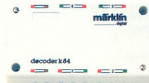
6084 · Décodeur k 84 · Module décodeur avec un contact permanent pour la télécommande d'éclairages, moteurs et autres éléments électriques sur un réseau digitalisé · 4 x 3 prises branchées à un inverseur hors potentiel · 3 x 2 prises pour le branchement à la Central Unit, à la voie et pour la liaison avec d'autres décodeurs k 84 ou k 83 · Clavier de codage · Dimensions 22 × 54 × 100 mm
