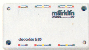
6083 · Décodeur k 83 · Élément récepteur pour aiguillages, signaux et éléments détecteurs dans un réseau à commande Märklin Digital · Convient pour 4 articles à bobine double ou 8 articles à une bobine · 4 x 3 prises pour le branchement des articles télécommandés · 2 prises pour le branchement à la voie et 2 prises pour le branchement d'un autre décodeur · Clavier de codage pour l'attribution d'un numéro de code · 2 résistances pour signaux sont jointes · Dimensions 22 × 54 × 100 mm
